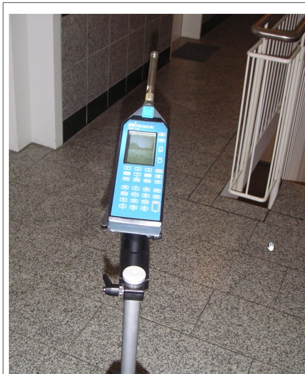
Aufzeichnung des Brummttons mit einem kalibrierten und geeichten Schallpegelmessgerät zu Nachtzeiten in einem Gebäude.
